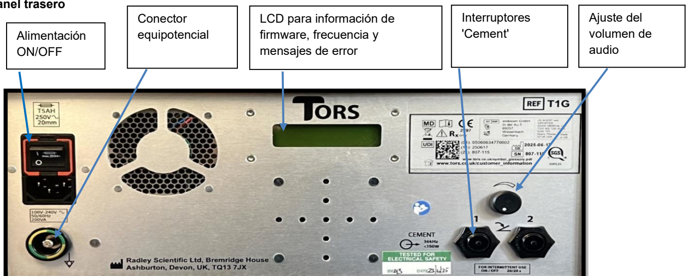
Figura 2: Panel trasero del generador TORS
